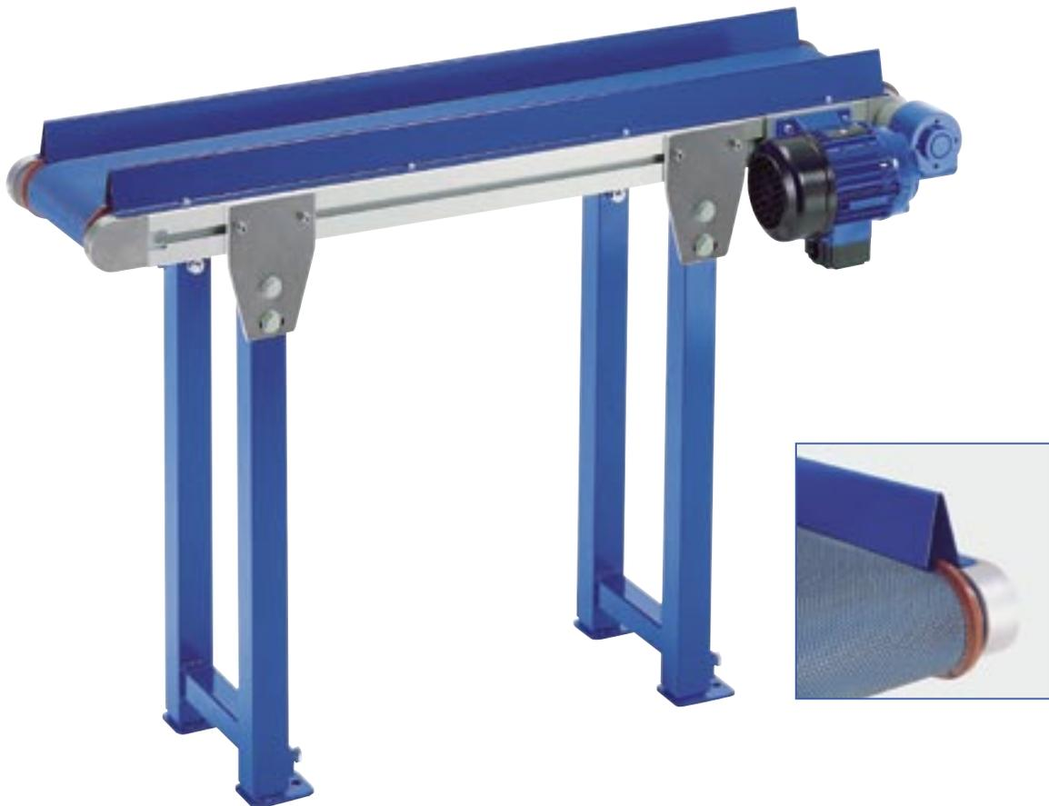
DasFröhlichBand Stanzabfall-Förderbänder sind Spezialisten für den Abtransport von scharfkantigen Teilen. Durch die besondere Kombination von Dach- und Keilleiste wird das Eindringen von Transportgut zwischen Gurt und Gleitblech verhindert. Das Ergebnis: längere Standzeit des Gurtes sowie wartungsarme Einsatzzeiten des Förderbandes trotz extremen Bedingungen.
